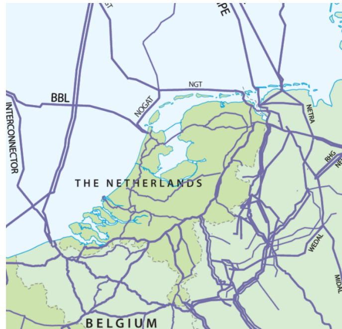
Abbildung 11 Transportnetz für Niederlande und einige Nachbarländer (nur mittlere (>600 mm) und große Pipelines (>900 mm) werden angezeigt)
