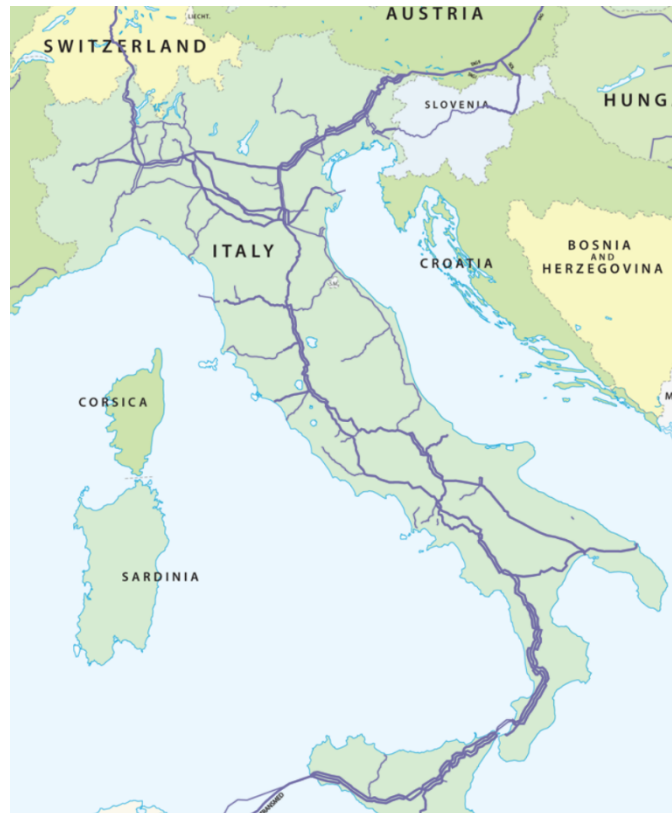
Abbildung 15 Transportnetz für Italien und einige Nachbarländer (nur mittlere (>600 mm) und große Pipelines (>900 mm) werden angezeigt)
