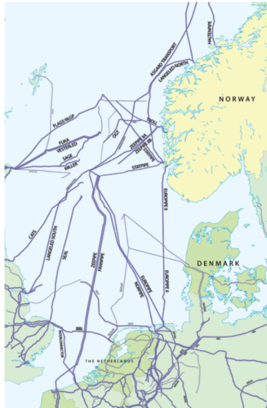
Abbildung 8 Transportnetz für Norwegen und einige Importländer (nur mittlere (>600 mm) und große Pipelines (>900 mm) werden angezeigt)
